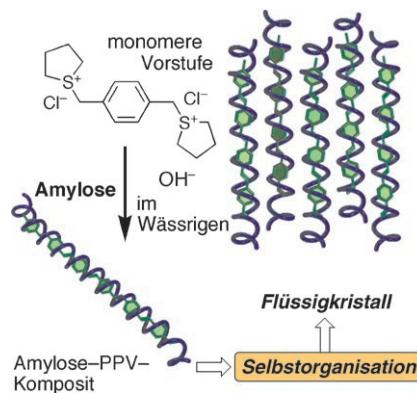
**Aufgereiht:** Ein lumineszierendes Komposit aus Poly(*p*-phenylenvinylene) (PPV) und Amylose wurde durch direkte Polymerisation der monomeren Vorstufe im Wässrigen in Gegenwart von Amylose erhalten. Dieses Komposit besteht aus einem stäbchenförmigen PPV-Segment, das in eine flexible Amyloseröhre eingefädelt ist, und bildet durch Selbstorganisation flüssigkristalline Phasen.
